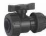
PP Ball Valve Female Union DN.1/2" - DN.2" PN.16
