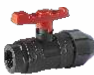
PP Ball Valve Female DN.20 - DN.110 PN.16/PN.10
